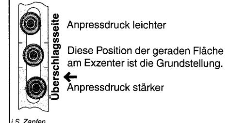
Diese Position der geraden Fläche am Exzenter ist die Grundstellung.
