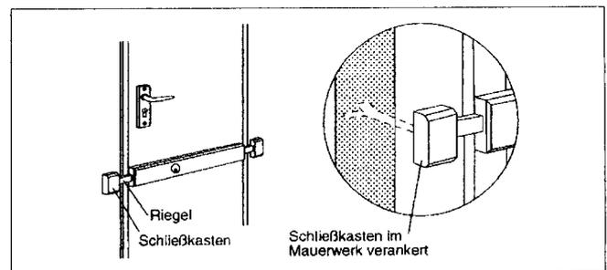
**Sicherungshinweis:** Haben Türen außenliegende Türbänder, müssen zwei Hinterhaken zur Stabilisierung angebracht werden. Sofern ein Querriegelschloß vorhanden ist, kann auf zusätzliche Hinterhaken verzichtet werden. Montage: im Bandbereich am oberen und unteren Türdriftel, bei Metalltüren aufgeschweißt, bei Holztüren aufgeschraubt oder im Mauerwerk verankert. Preise ca. 15 EUR - 40 EUR \*)
