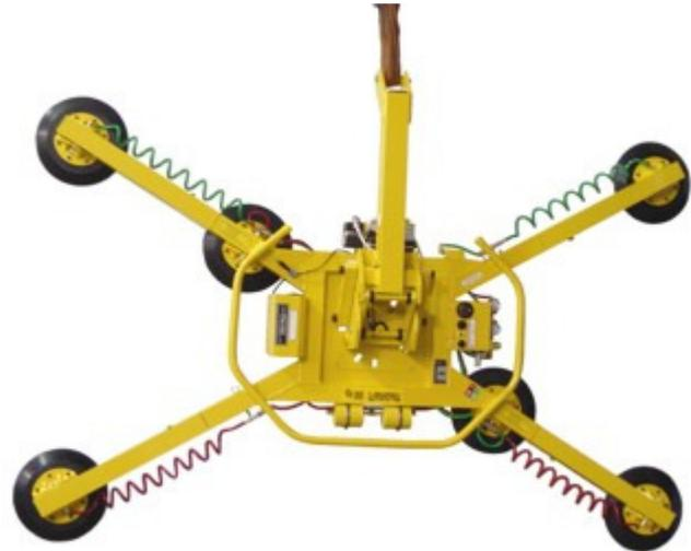
**Zusätzlich zum Powr-Grip® Doppelvakuumssystem bietet dieses gleichstrombetriebene Vakuum-Hebezeug unser innovatives „Quadra-Tilt“ Kippgestänge, eine kontinuierliche 360°-Drehleistung und verschiedene Rahmen-Konfigurationen; so gewährleistet es maximale Sicherheit und Vielseitigkeit auf der Baustelle und in der Werkstatt.**
